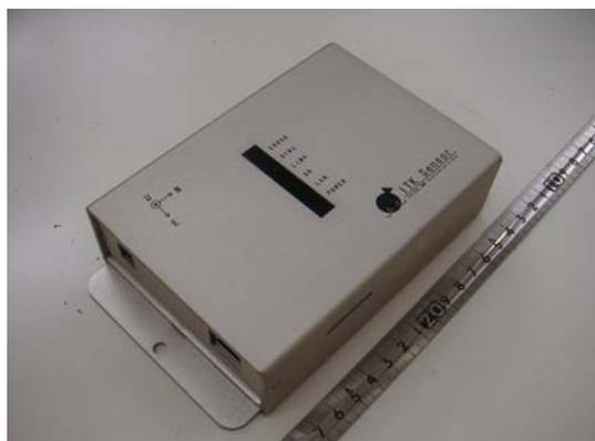
図 1：残余耐震性能判定装置試作機(エーラボ)
