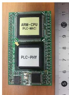
図 2：電力線通信モジュール(ネクス)
